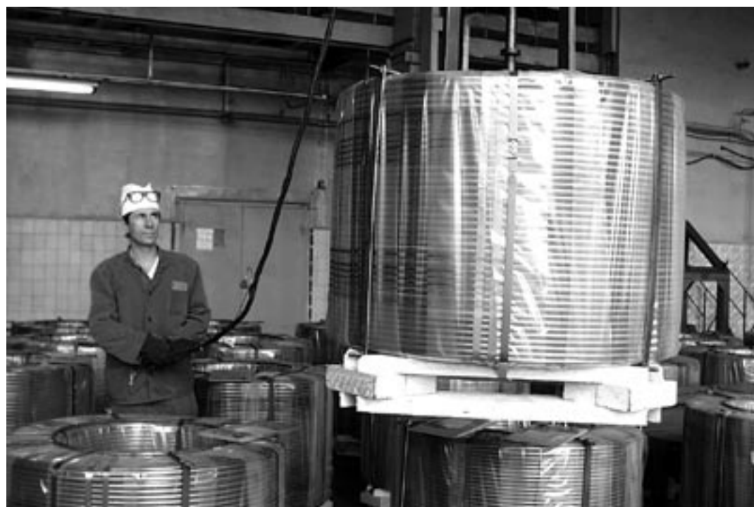
Складирование бунтов порошковой проволоки
